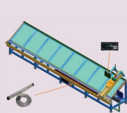
Usando una escala ABSOLUTE Digimatic combinada con un sistema de posicionamiento y visión de lupa, se puede desarrollar fácilmente un sistema para medir el ancho y el largo de las películas plásticas.
