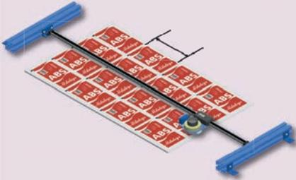
Usando una escala ABSOLUTE Digimatic combinada con un sistema de posicionamiento y visión de lupa, se puede desarrollar fácilmente un sistema para medir el ancho y el largo de las películas plásticas.
