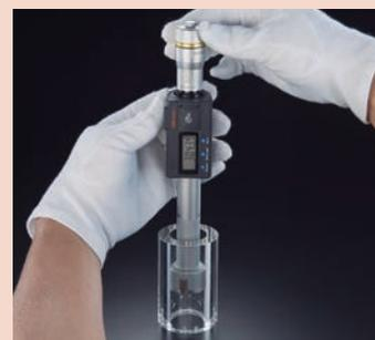
Funciones\*: configuración en origen, puesta a cero en cualquier punto y detención de lectura
