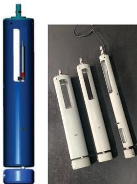
Dispositivo de fijación de tapa para medición en la máquina óptica CNC
