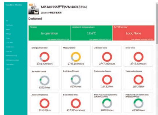
Software que monitorea el estado de la máquina y sus elementos, creando un libro de registro para verificar la salud del equipo.
